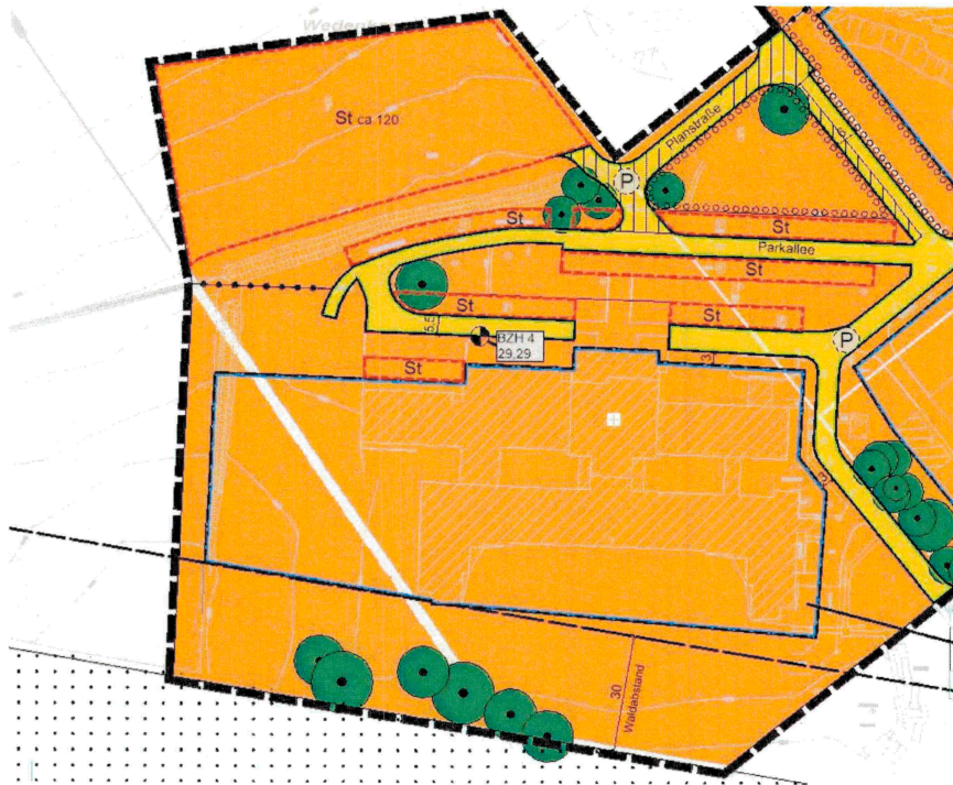
Abbildung 26 - Nördlich Stellplatzfläche („St ca. 120“ rotes Rechteck) und westlich die Erweiterungsfläche des Gebäudes PA 35 (Baugrenze minus Bestandgebäude)
