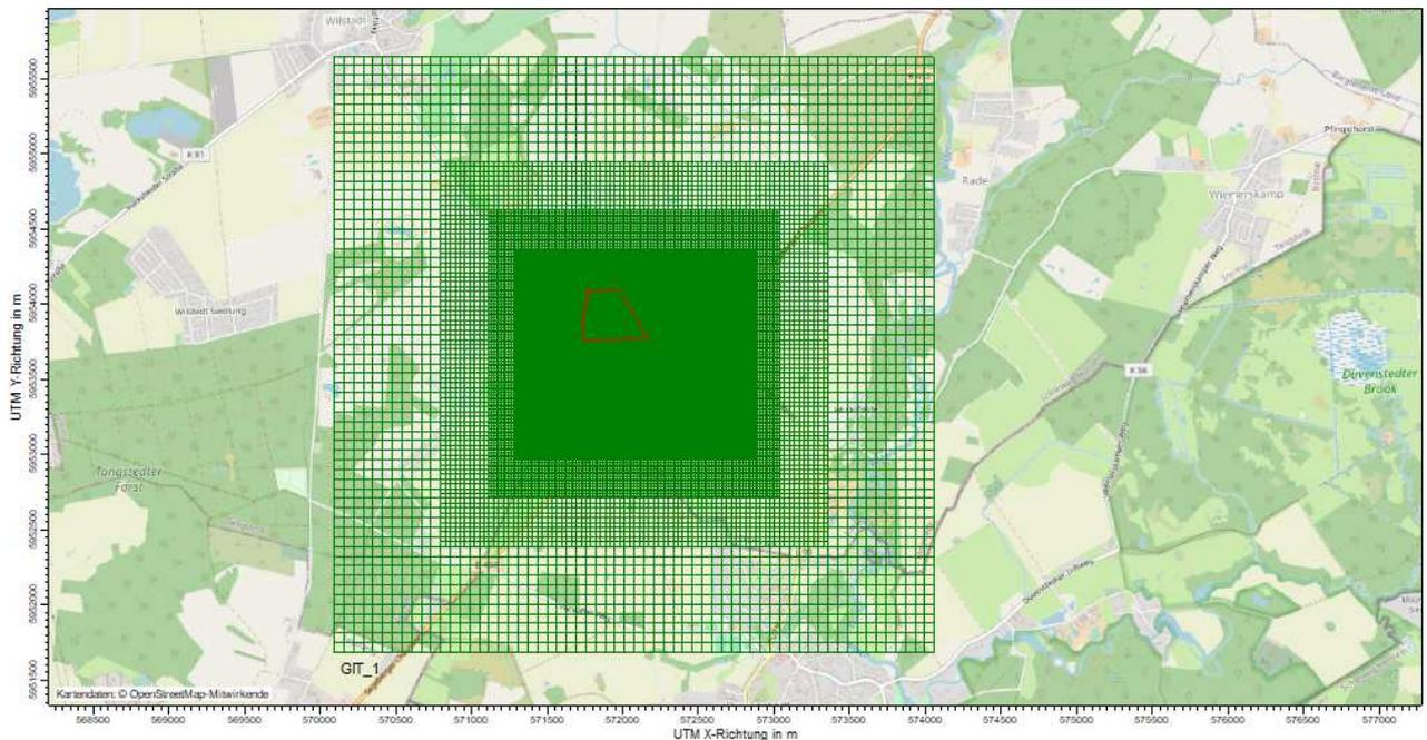
Abbildung 6.7: Rechengitter von innen nach außen: 8 m / 16 m / 32 m / 64 m (aus austrialview)
