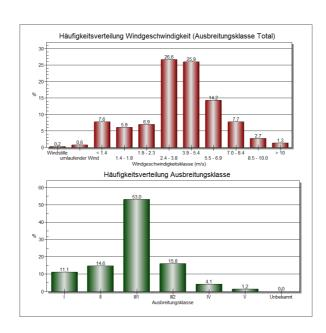
Abbildung 6.3: Häufigkeitsverteilung Windgeschwindigkeiten/Ausbreitungsklassen, Station Hamburg-Fuhlsbüttel, Zeitraum 01.01.2019-31.12.2019.
