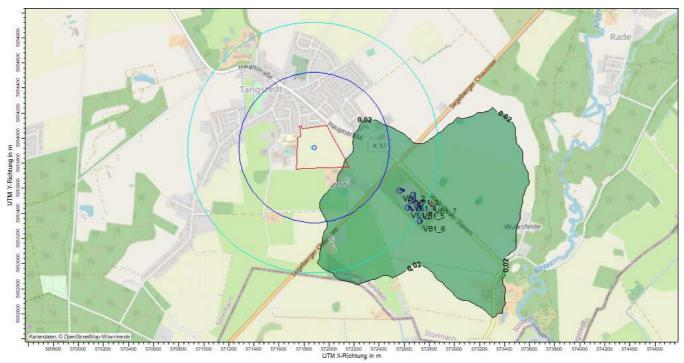
Abbildung A.4.4: 2%-Isolinie der Vorbelastung VB1 (grün); Kennzeichnung des Beurteilungsgebietes (rot) und der Abstandskreise 1000 m (hell blau) und 600 m (dunkelblau) (Kartengrundlage: Austalview, Openmaps) (Biogasund Kompostwerk Bützberg). [BC-P20041-101]
