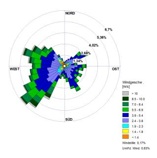
Abbildung 6.2: Richtungsabhängige Verteilung der Windgeschwindigkeiten, Station Hamburg-Fuhlsbüttel, Zeitraum 01.01.2019-31.12.2019.
