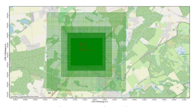
Abbildung 6.7: Rechengitter von innen nach außen: 8 m / 16 m / 32 m / 64 m (aus austalview)
