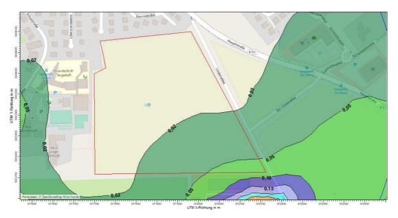
Abbildung 7.1: Isoplethen der Geruchsbelastung in Prozent der Jahresstunden; roter Rahmen: Plangebiet (BC-20041-112).
