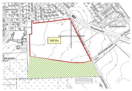
Abbildung 1.1 Auszug aus der Flurkarte mit Kennzeichnung der Planfläche; rot: Geltungsbereich des Entwurfs des Bebauungsplans; grün + rot: Beurteilungsgebiet dieser Immissionsprognose:
