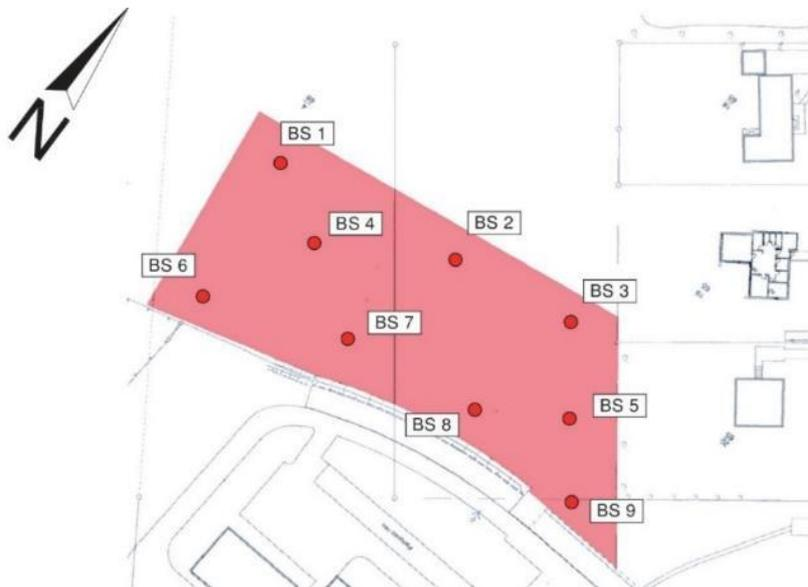
Abbildung 18 - Lageskizze der Bohrpunkte, Auszug aus der Baugrunduntersuchung
