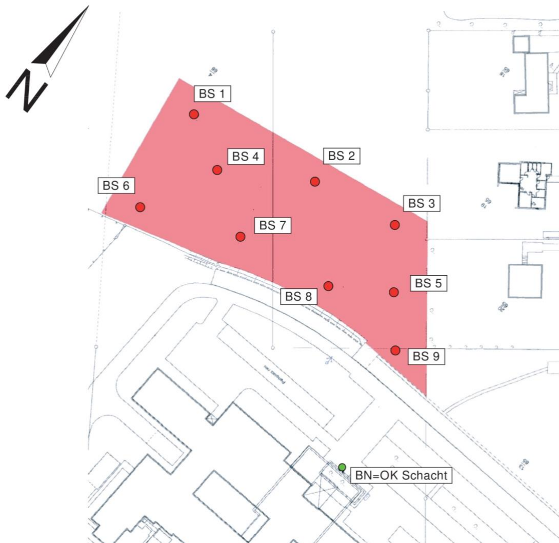
Abbildung 9: Lageskizze der Bohrpunkte, Auszug aus der Baugrunduntersuchung
