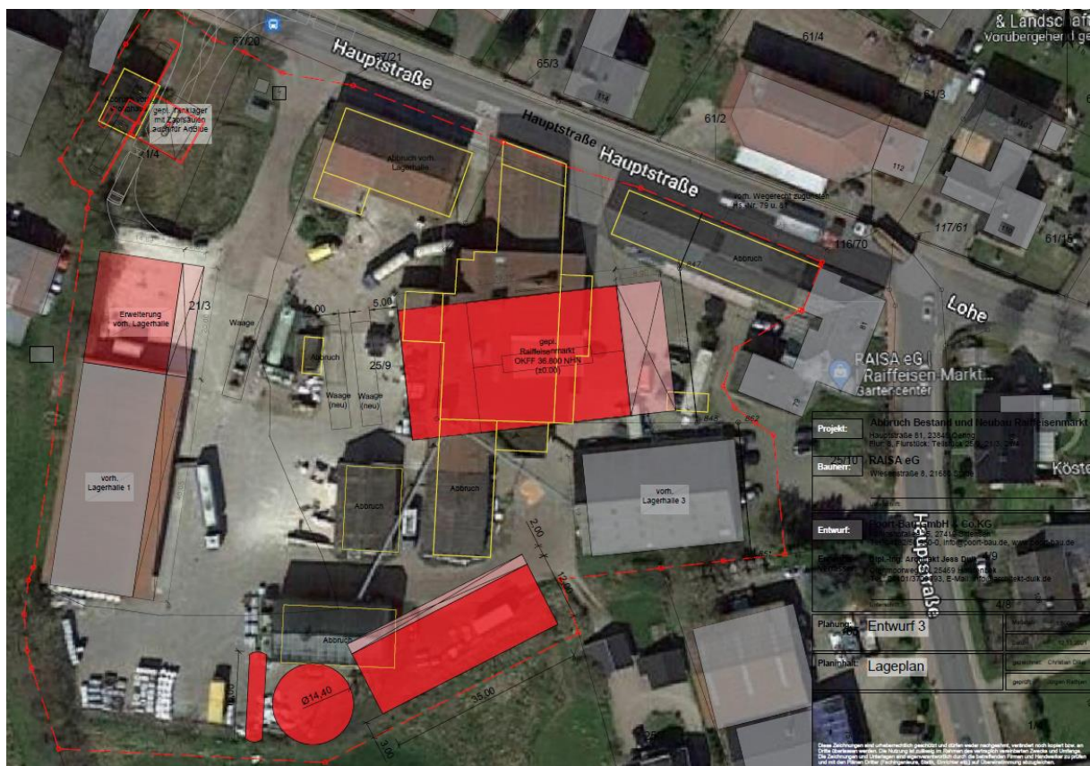
Abb. 2: Entwicklungskonzept, gelb Abbruch, rot Neubau, grau Bestand
