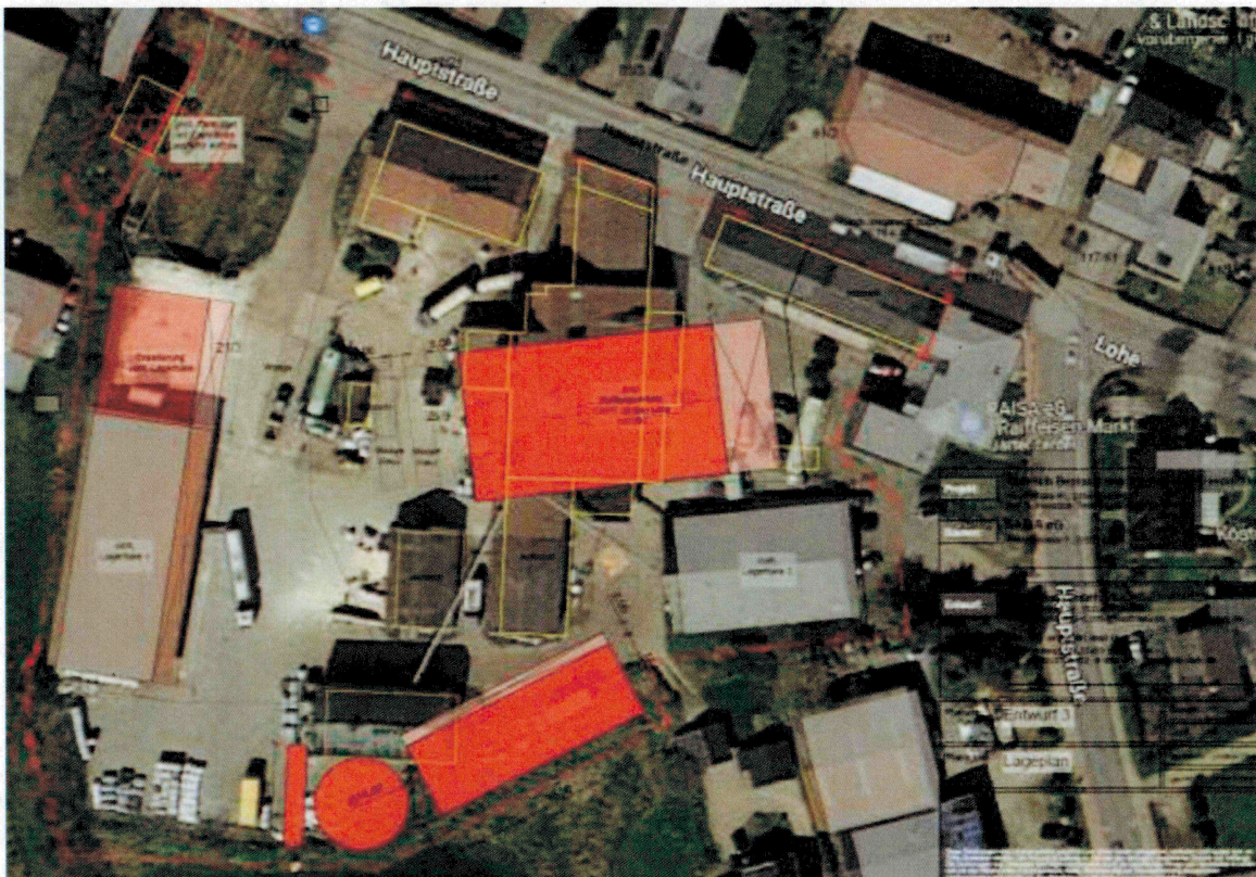
Abb. 2: Entwicklungskonzept, gelb Abbruch, rot Neubau, grau Bestand
